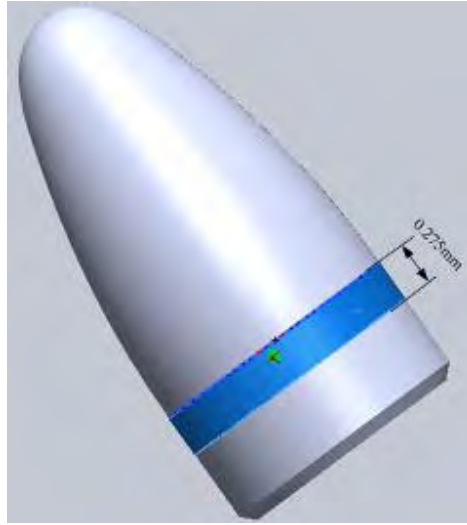
图 5-2 弹痕痕迹相对平稳处的位置示意
