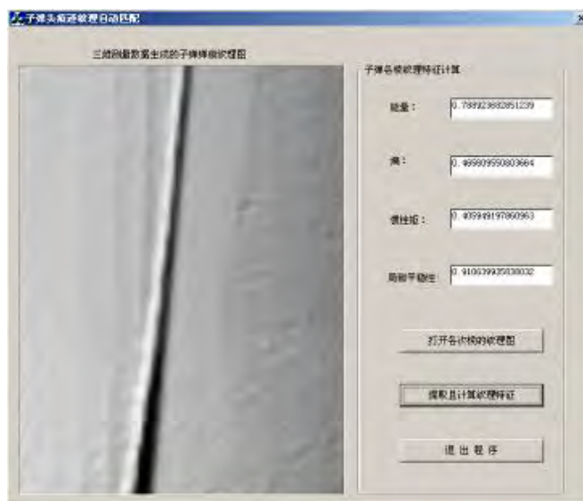
图5-16 提取、计算擦痕纹理图的四个特征值
