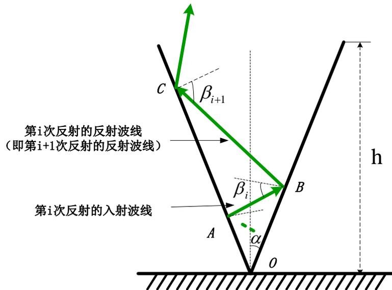
图 3. 波线向上反射角度示意图
