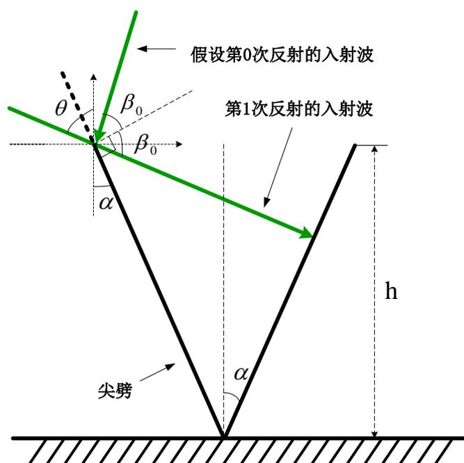
图 1. 第 0 次反射的入射角示意图
