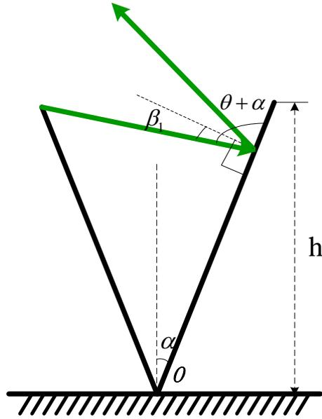
图 9. 入射波打到尖劈右侧内板直接反射出去情形示意图
