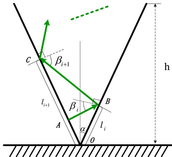
图 7. 波线向上反射距离示意图
