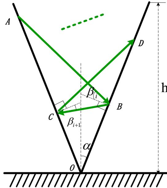
图 4. 波线由向下反射转变到向上反射的临界角度示意图
