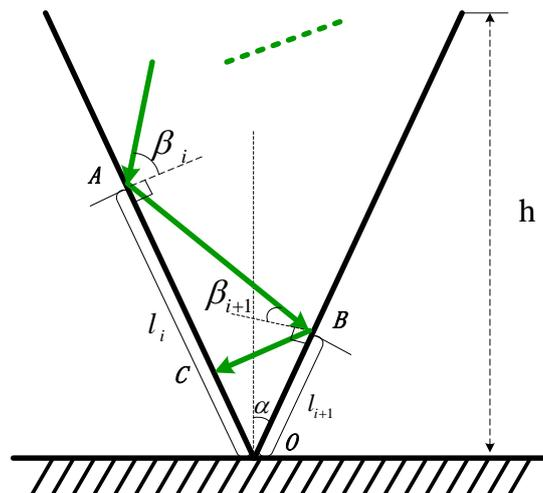
图 6. 波线向下反射距离示意图
