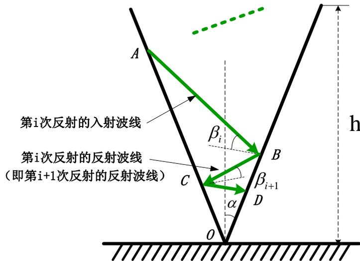
图 2. 波线向下反射角度示意图
