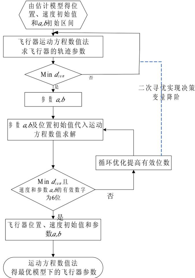
图 7 循环缩小区间降阶优化模型流程图
