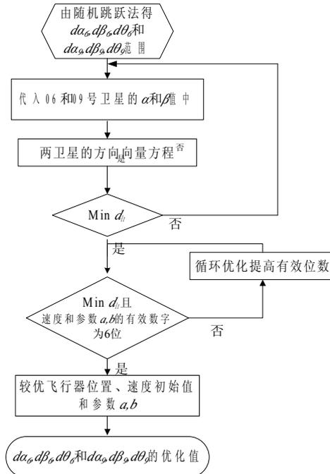
图 12 系统误差最优值搜索算法流程图
