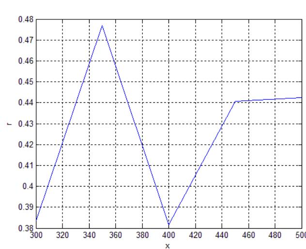
图 5.5 一阶矩与接收机位置相关系数随发射机位置变化规律
