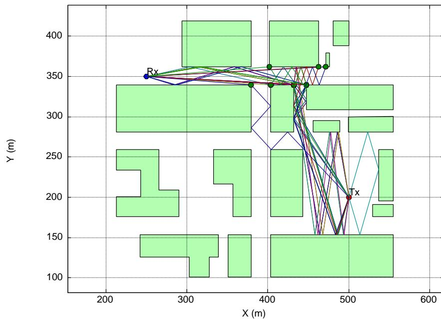
图 4.15 含且仅含 1 个绕射点路径图 (29 条)
