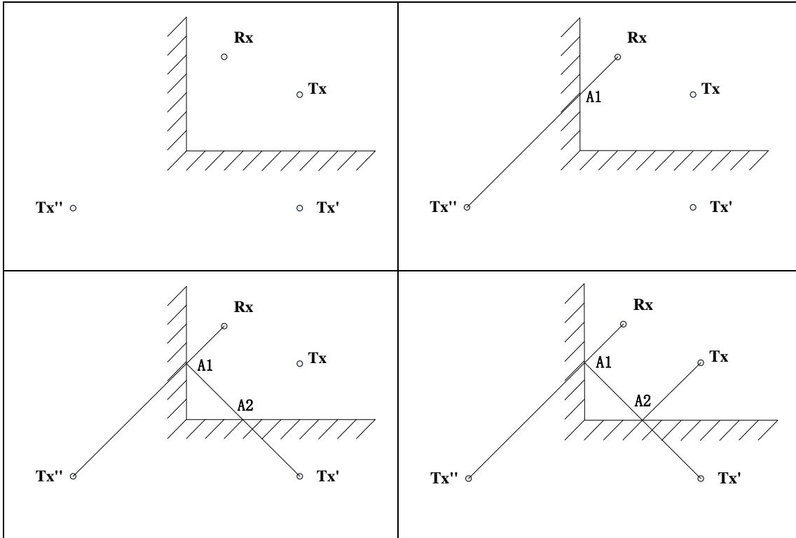
图 4.13 根据有效像点确定反射路径
