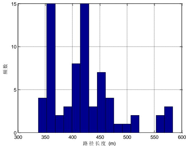
图 4.19 二次绕射路径长度分布直方图
