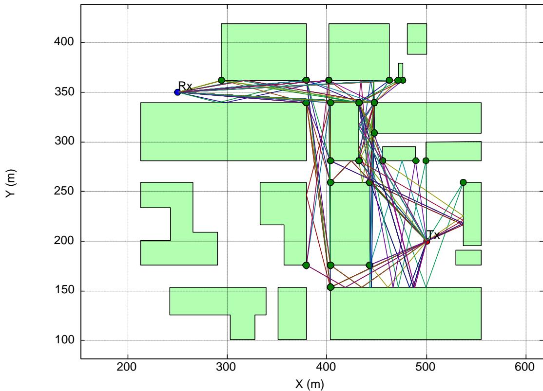
图 4.16 含且仅含 2 个绕射点路径图 (70 条)
