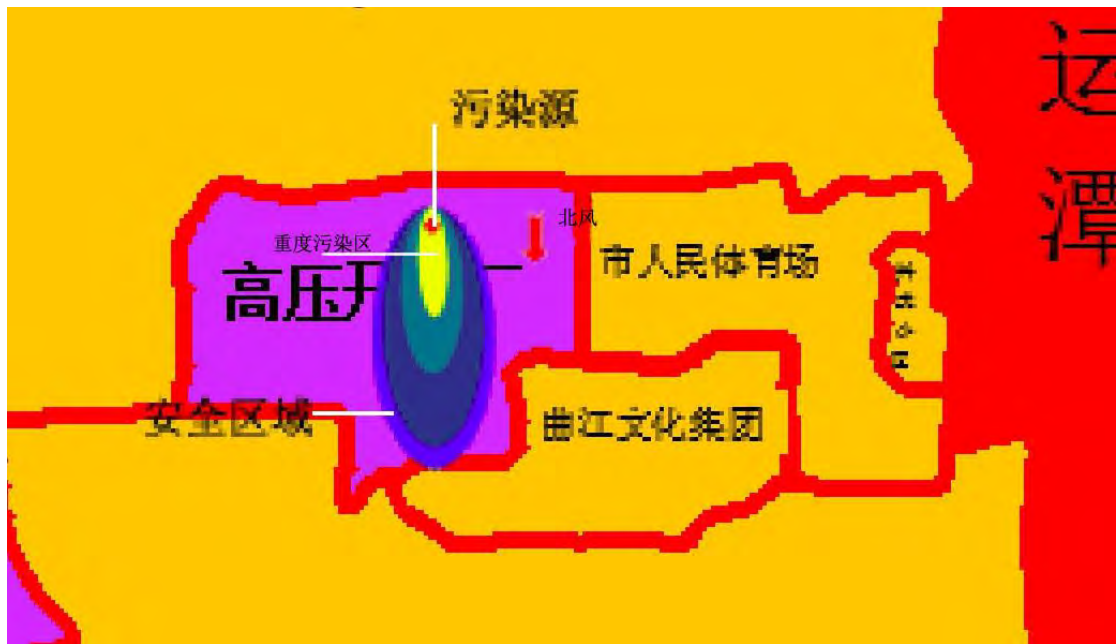
图 7-5 在点源模式下，PM2.5 颗粒污染物浓度扩散示意图
